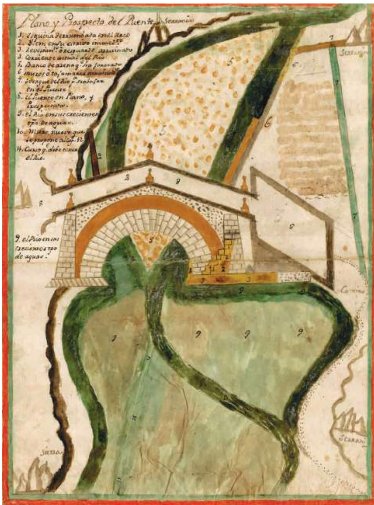
Fig. 7. Puente del Pilcomayo - S. XVIII. Fuente: Archivo Nacional de Bolivia. EC 1778, 111 (Esquema del puente y sus daños).
